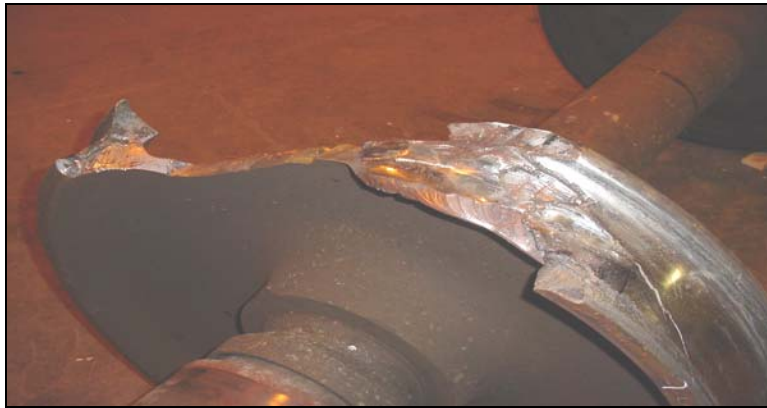
Photo 4. Roue brisée du wagon CNWX 111231
