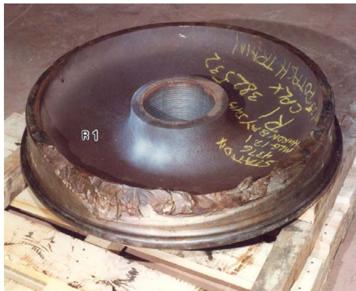
Photo 3. Roue R1 brisée du wagon CPLX 382532
