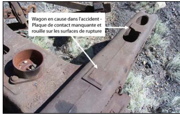
Photo 13. Wagon en cause dans l'accident avec plaque de contact manquante (Source : CN)
