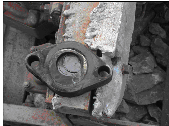
Photo 6. Clapet de non-retour défectueux de la locomotive
