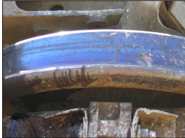
Photo 12. Roues de la locomotive après le déraillement
