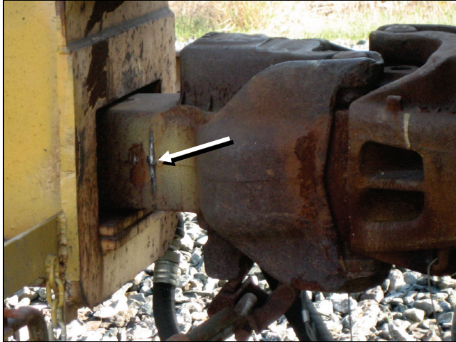
Photo 2a. Rainures profondes sur le côté du bras d'attelage du wagon n° BGSX 122226
