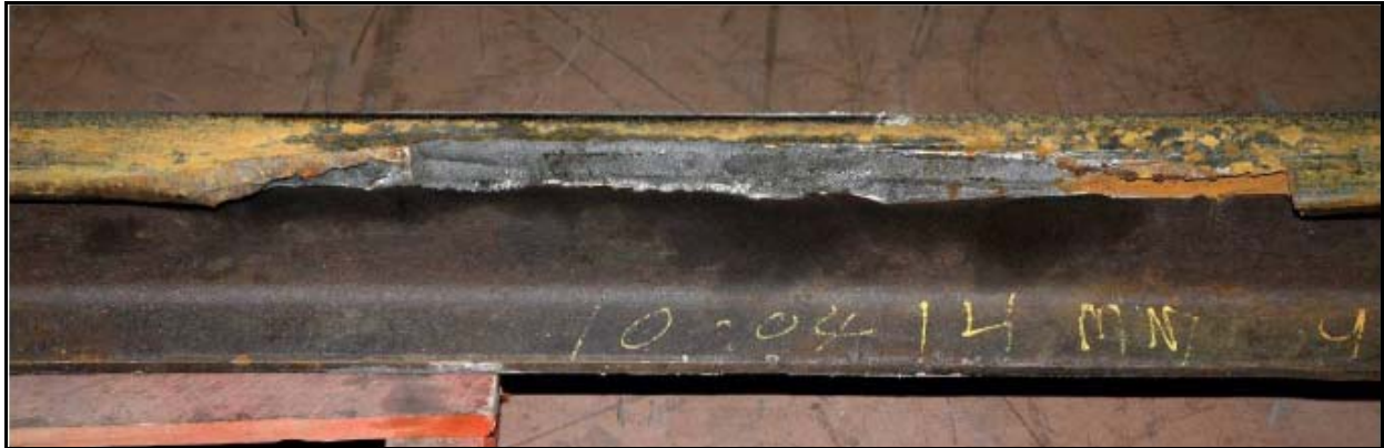
Photo 2. Fissuration verticale du champignon du coupon de rail Dominion
