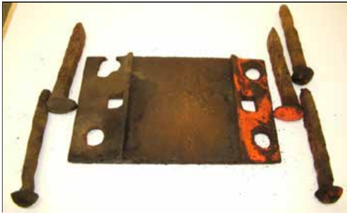
Photo 9. Selles de rail de style plus ancien et crampons à section arrondie
