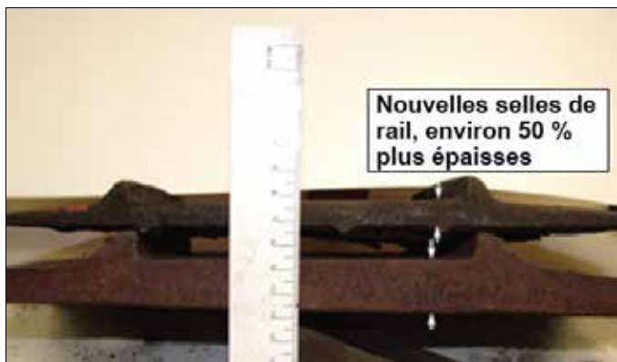
Photo 12. Type de selle de rail plus ancien de 10 pouces superposé sur une nouvelle selle de rail de 14 pouces. La base de la selle de 10 pouces fait environ la moitié de l'épaisseur de la base de la selle de 14 pouces.
