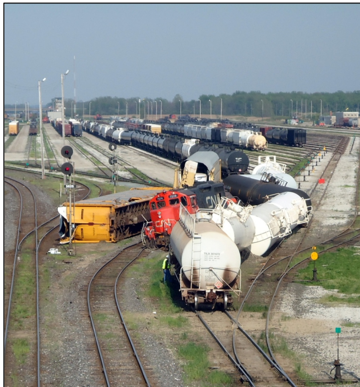
Photo 1. Wagons déraillés, en regardant vers le sud-est
