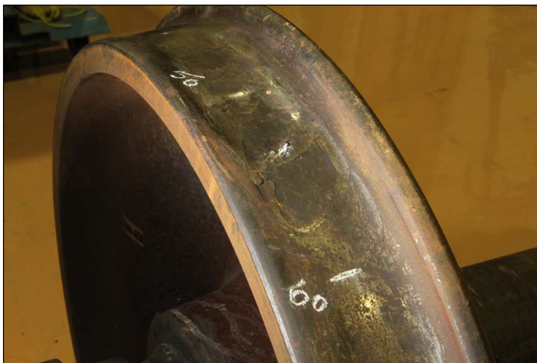
Photo 2. Méplats sur la roue R2 de l'essieu monté n° 2
