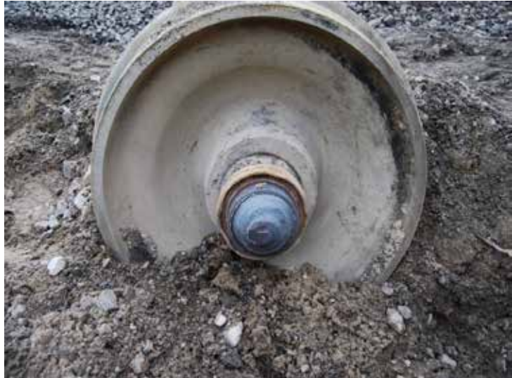
Photo 2. Roue L3 et fusée d'essieu surchauffée du DTTX 680968
