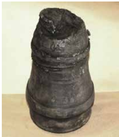
Photo 4. Capuchon de la fusée d'essieu surchauffée ayant cédé
