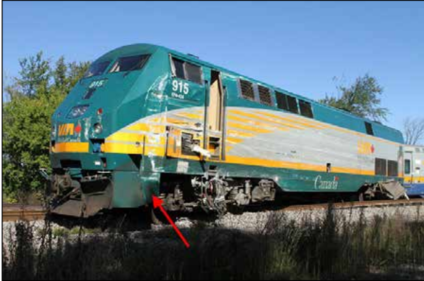
Photo 5. Dommages sur la locomotive VIA 915
