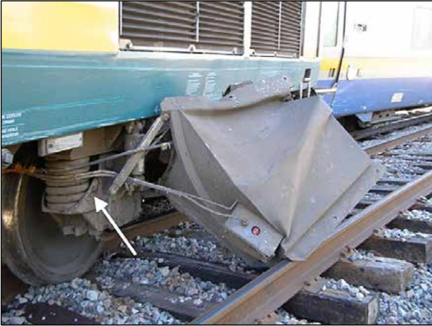
Photo 6. Marque d'impact sur le longeron du bogie arrière de la locomotive VIA 915 (flèche) et coffre de batterie détaché
