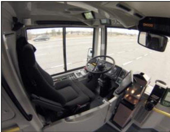
Photo 17. Poste de conduite de l'autobus ADL E500
