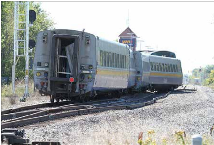
Photo 8. Vue vers l'ouest des voitures déraillées et de la voie déplacée
