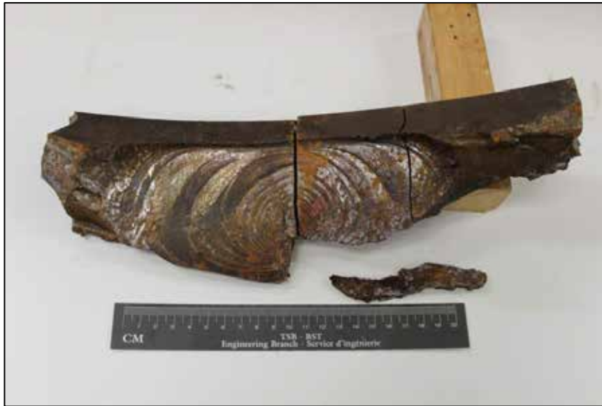
Photo 3. Éclatement de la jante de la roue L3
