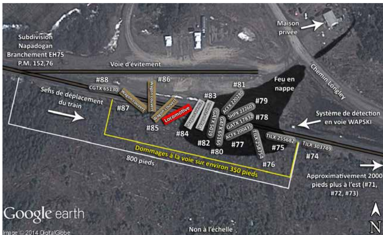
Figure 2. Diagramme de l'empilement des wagons déraillés (Source : Google Earth, avec annotations du BST)
