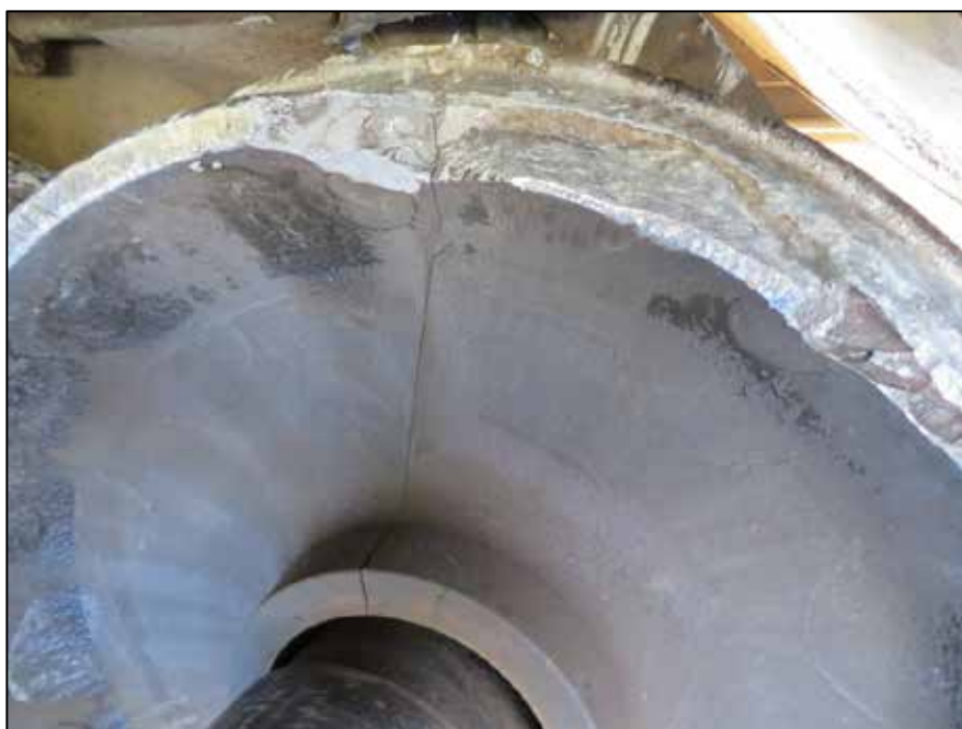
Photo 2. Fissure de la roue L3 du wagon CRDX 15109
