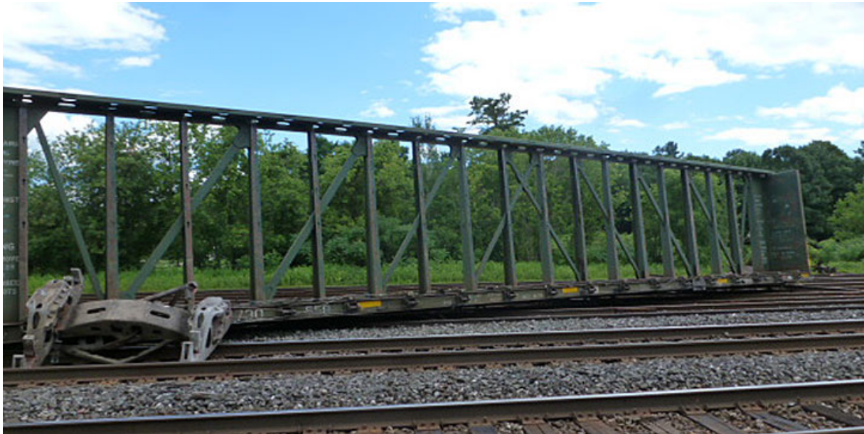
Photo 1. Premier wagon déraillé, le wagon plat à parois de bout et à support central en A BCOL 730558
