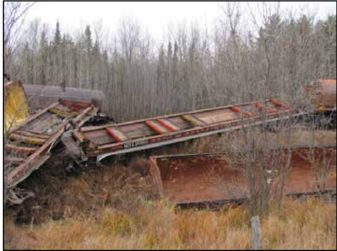
Photo 4. Wagons-tombereaux couverts vides déraillés additionnels
