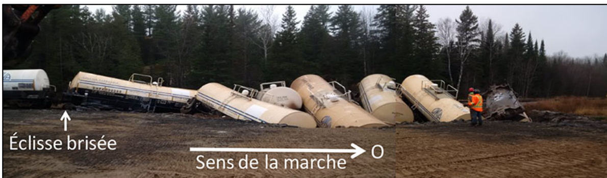
Figure 2. Wagons-citernes déraillés dans diverses positions
