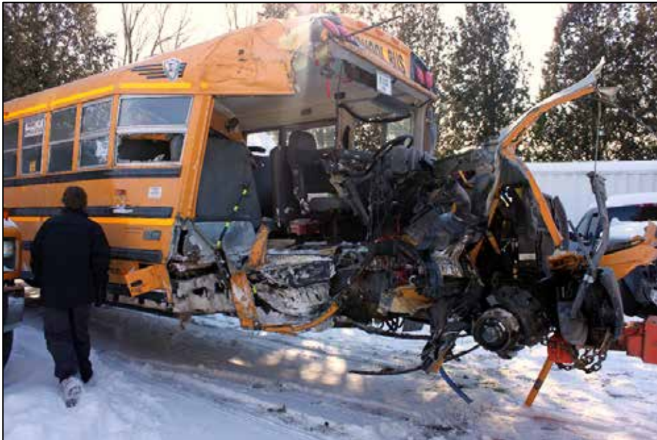
Figure 3. Côté passager avant de l'autobus scolaire endommagé
