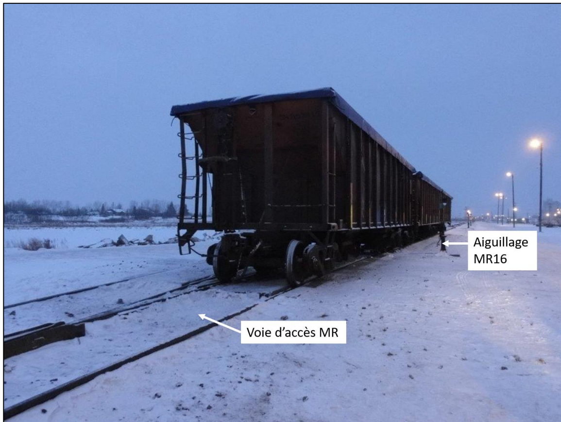
Figure 3. Wagons-trémies découverts en cause dans l'événement, mis en transition sur la voie d'accès MR près de l'aiguillage MR16 (Source : Compagnie des chemins de fer nationaux du Canada, avec annotations du BST)
