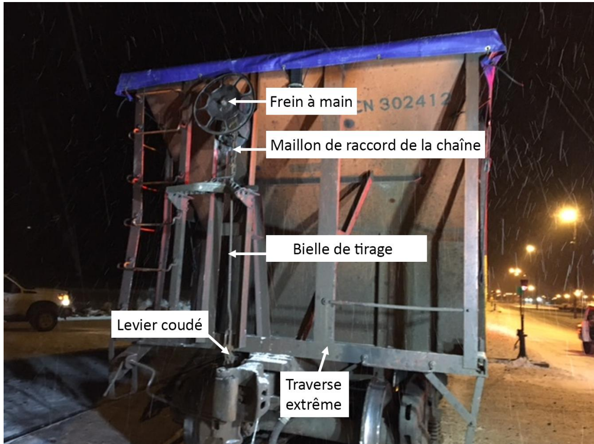
Figure 5. Bout B du wagon CN 302412, tel qu'il était environ 30 minutes après l'accident (Source : Compagnie des chemins de fer nationaux du Canada, avec annotations du BST)
