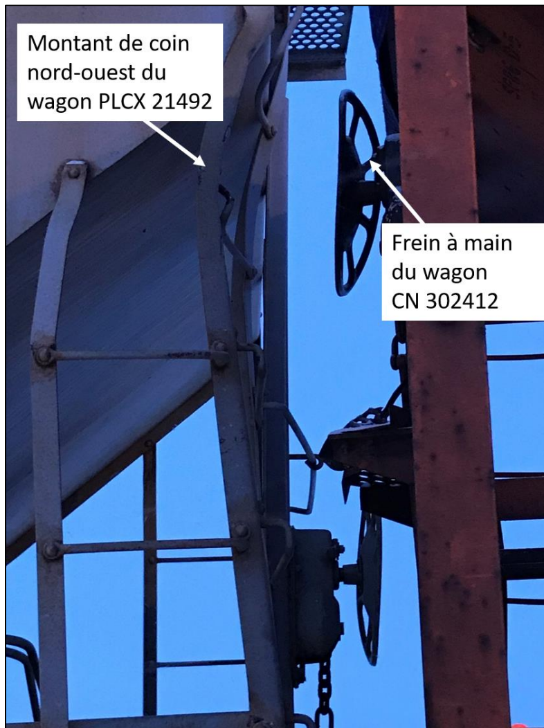
Figure 4. Estimation de la façon dont les wagons PLCX 21492 et CN 302412 se sont immobilisés, d'après une reconstitution effectuée le lendemain (Source : Compagnie des chemins de fer nationaux du Canada, avec annotations du BST)
