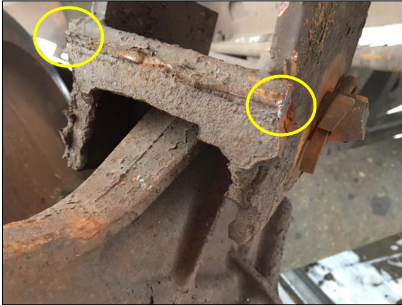
Figure 7. Surface de rupture du support du levier coudé comprenant 2 petites zones de rupture récente (encerclées) (Source : Compagnie des chemins de fer nationaux du Canada, avec annotations du BST)
