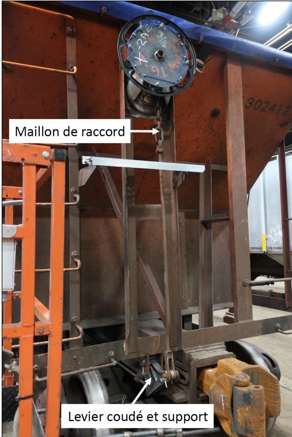
Figure 10. Bout B du wagon CN 302412 dans l'atelier, frein à main serré (Source : BST)
