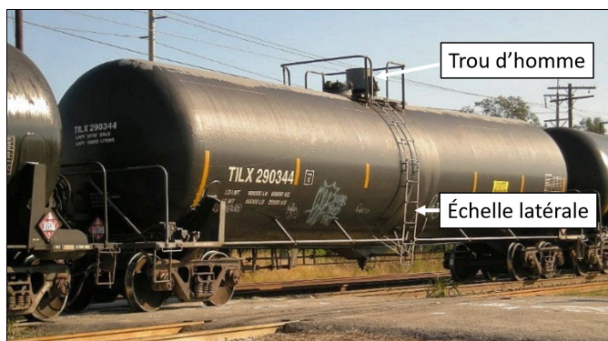
Figure 2. Wagon-citerne typique avec trou d'homme et échelle latérale (Source : BST)
