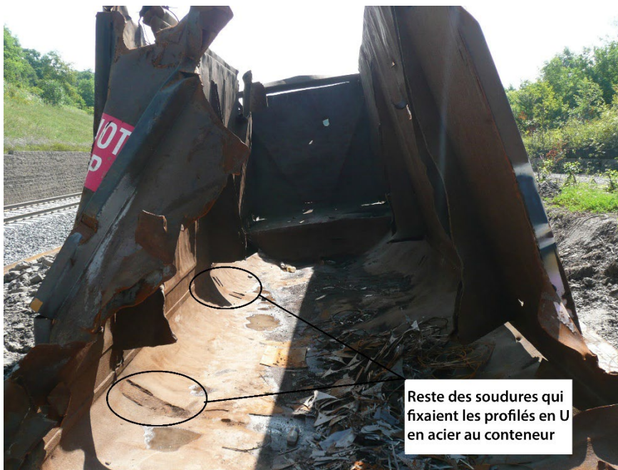
Figure 26. Wagon DJJX 30478, vue de l'intérieur du wagon à partir du bout A (Source : BST)
