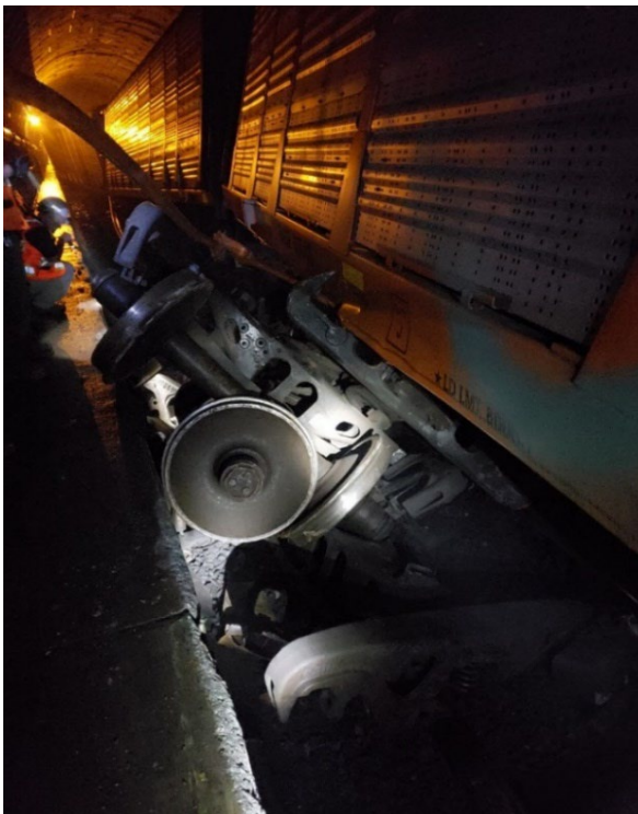
Figure 13. Essieux montés déplacés, bogies et wagons déraillés du côté canadien (Source : BST)
