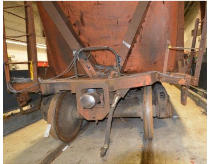
Figure 31. Défaillance AG du wagon DJJX 30156 pendant l'essai (Source : Conseil national de recherches Canada)
