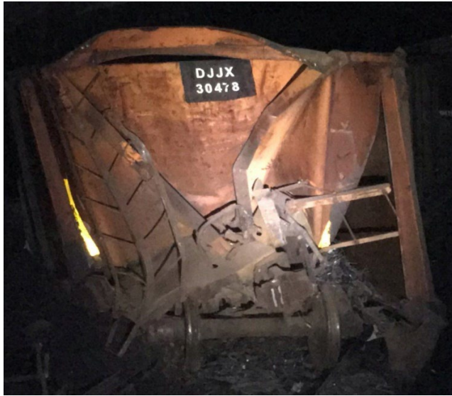
Figure 30. Défaillance AG du wagon DJJX 30478 dans le tunnel (Source : Federal Railroad Administration)
