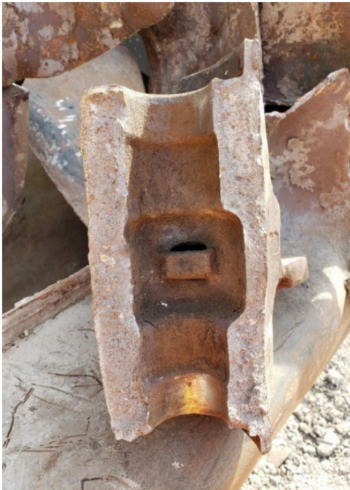
Figure 7. Surface de rupture de la mâchoire d'attelage brisée du bout A du wagon DJJX 30478 (53 e position) (Source : BST)
