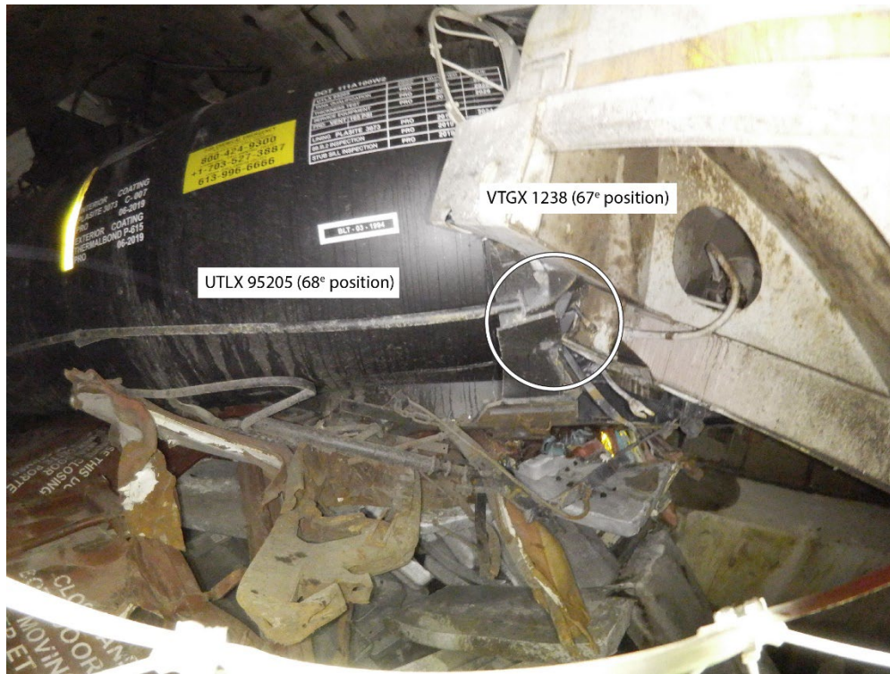
Figure 17. Vue aérienne de la tête de citerne du bout B avant du wagon UTLX 95205 (68 e position), qui a été perforée par l'attelage et la longrine tronquée du wagon VTGX 1238 (67 e position) (Source : CN et Exelon Energy, avec annotations du BST)
