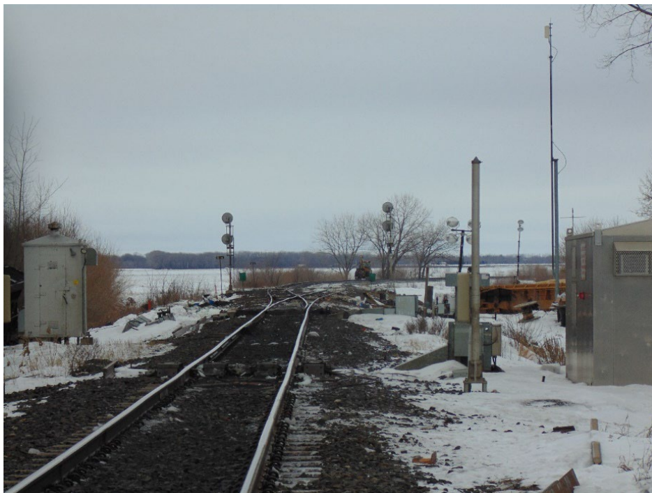
Figure 8. Vue vers l'ouest du signal 504S et du signal 504N à Nattress montrant la transition d'une voie principale double à une voie principale simple (Source : BST)
