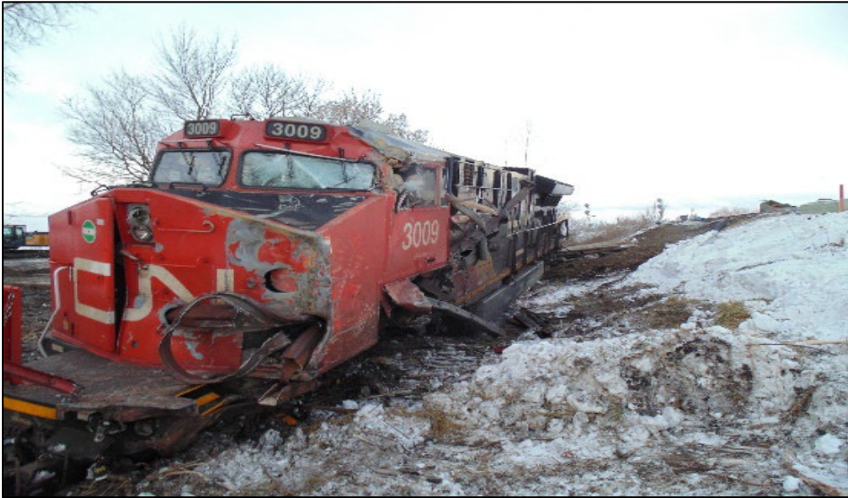
Figure 3. Dommages subis par le côté nord de la locomotive CN 3009 du train 318 (Source : BST)
