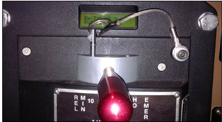
Figure 7. Poignée du frein automatique, dans une locomotive plus récente, munie d'une goupille de sûreté insérée du côté gauche de la base afin d'empêcher le desserrage des freins automatiques (Source : BST)
